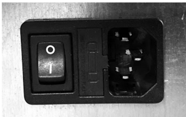
Fig. 27 - Presa elettrica con interruttore generale
