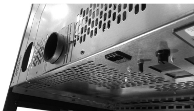
Fig. 49 - Rimozione tappo Frame 3
